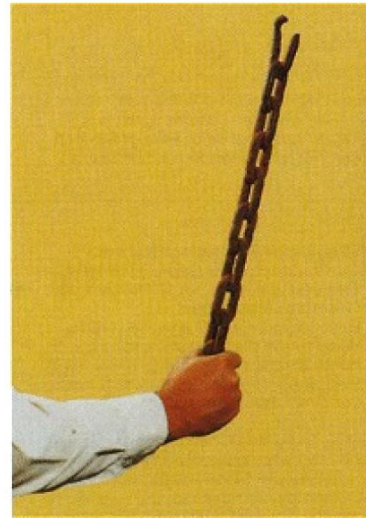
Bild 2 Kätting som dragits styv på grund av överbelastning
