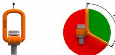
Bild 1: Tillåtna lastriktningar som uppstår vid korrekt användning. * Ringen ska inte vidröra lasten
