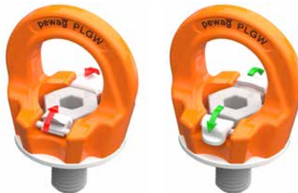
Bild 4: Position 'A' – båda spärrarna rör vid skruven. Endast tillåtet vid montering och demontering.
